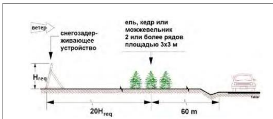
1.2.3 Сурет - Жас ағаштарды қар ұстайтын құрылғылармен отырғызуды күшейтудің уақытша схемасы.
